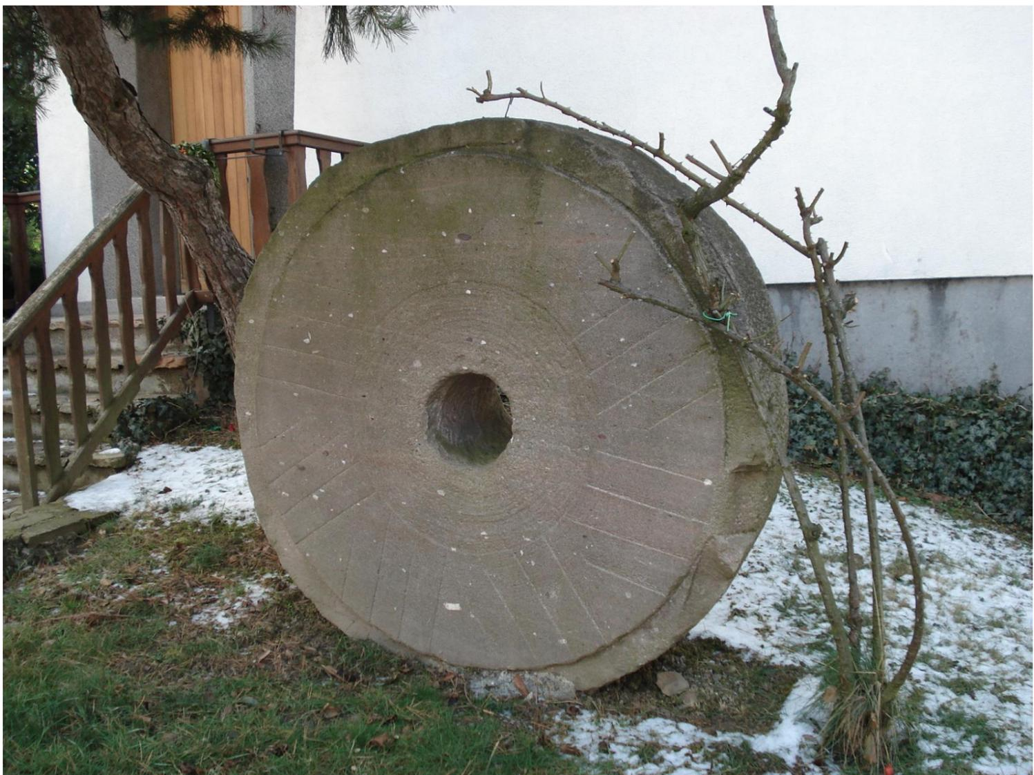
Ensemble d'un tournant du moulin du bas, composé d'une meule tournante appelée *courante* (photo du haut) et d'une meule fixe appelée *gisante* ou *dormante* ( photo du bas)
